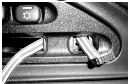
Рис. 2. Порядок укладки шлейфа.
