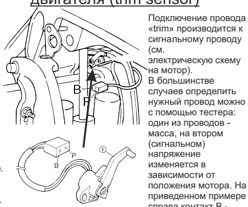
Подключение провода «trim» производится к сигнальному проводу (см. электрическую схему на мотор).
